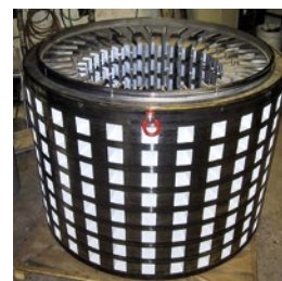
Produktionsudstyr med Accolan belægning
